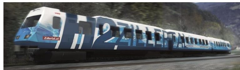
ZillertalBahn substituiert Dieselmotoren mit H2-Brennstoffzelle
